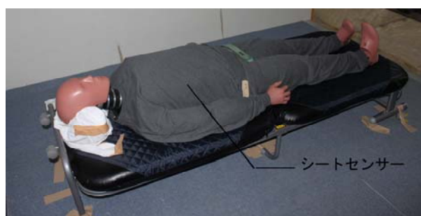
図 12 シートセンサー設置状況
