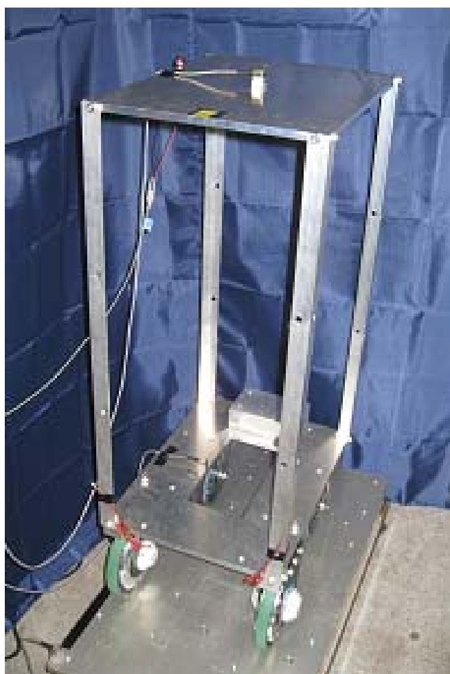
図 1 ER ブレーキ付車輪とキャスターワゴンの脚部
