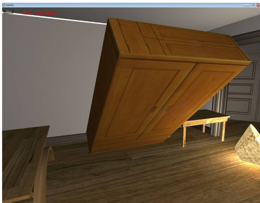
図 13 床応答入力による室内家具の挙動シミュレーション
