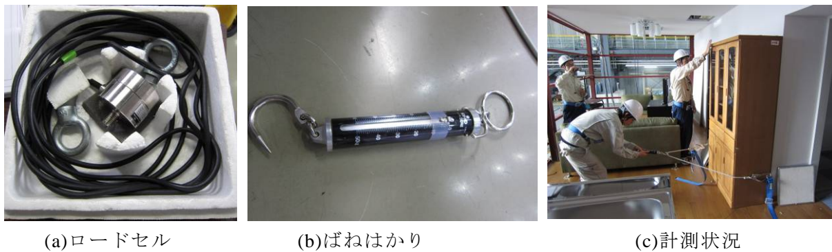
図 12 室内家具の摩擦力測定
