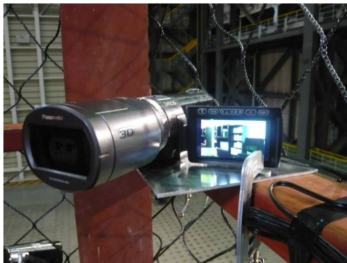
図 10 3D 撮影に対応した家庭用ビデオカメラ (E ディフェンス試験体への設置状況)
