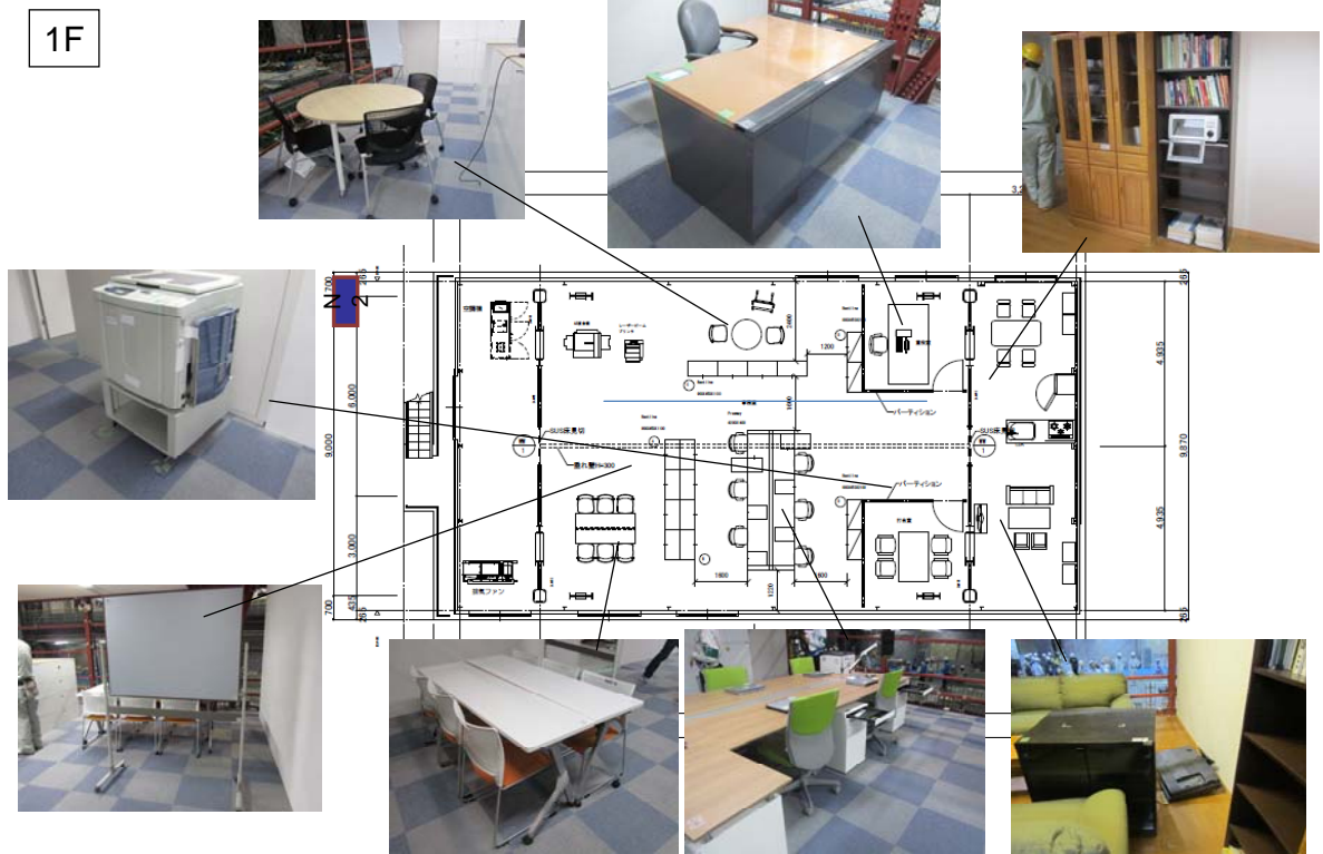
図 15(d) 加振後の室内状況とカメラ位置 (高層モデル 6 階相当、西新宿余震 330%入力)
