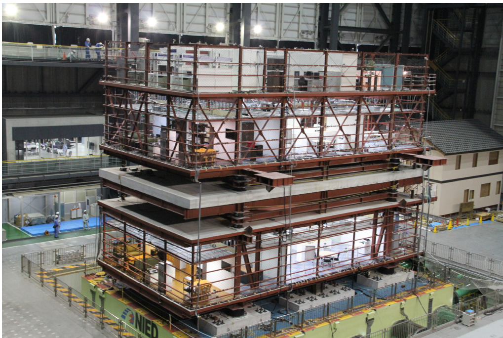
高層建物の上層階(27階)と下層階(6階)をモデル化した試験体
