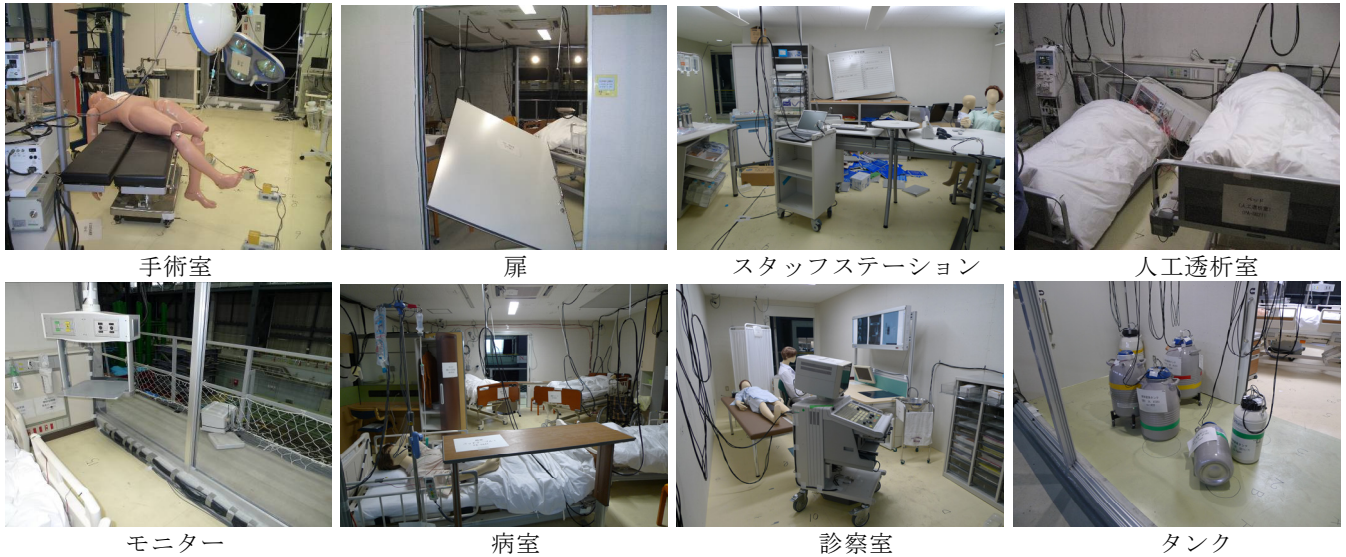
図 11 短周期地震動加振後の室内状況（耐震構造）
