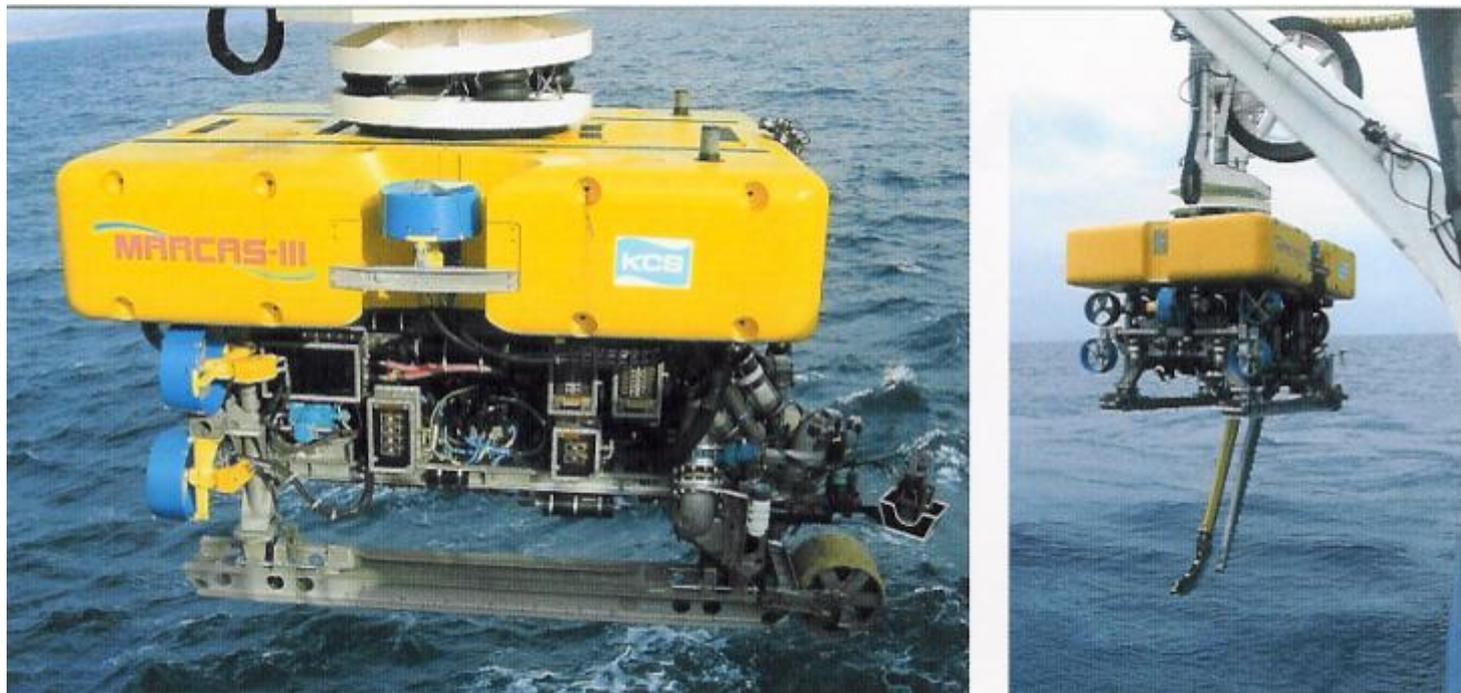
海底ケーブル工事に用いる深海作業ロボット(最大潜航深度2500m)の例
