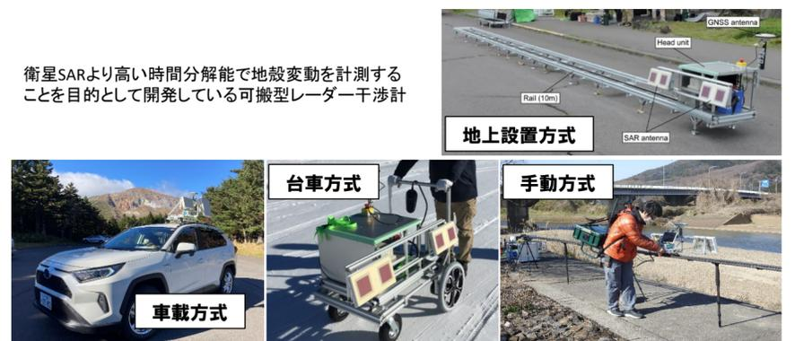
レーダー波を照射して観測するレーダー干渉計の開発を進めます。さらに、SARを用いて降灰情報等も得る技術開発を進めます。このように、火山活動把握、火山発生予測の高度化に資することを目的とし、さらなるSAR観測・解析技術の開発を進め、予測・情報力の強化を目指します。
