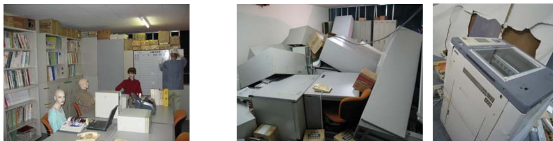
図10 オフィスの被害状況(左は加振前)
