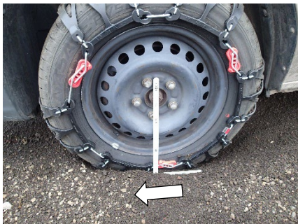
図 5. 樹脂製タイヤチェーンを装着して降灰路面を走行しスタックした車両の駆動輪。非装着時と同様にタイヤが降灰路面に沈み込んでいる。走破距離はタイヤチェーン非装着時と比べほぼ同じになった。試験車両と試験路は図 3 と同じ。
