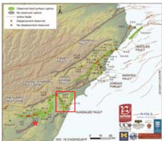
図2 2016年12月22日にまとめた地表断層の変位量 (H:水平; V:上下)である(GNS:2016)。
