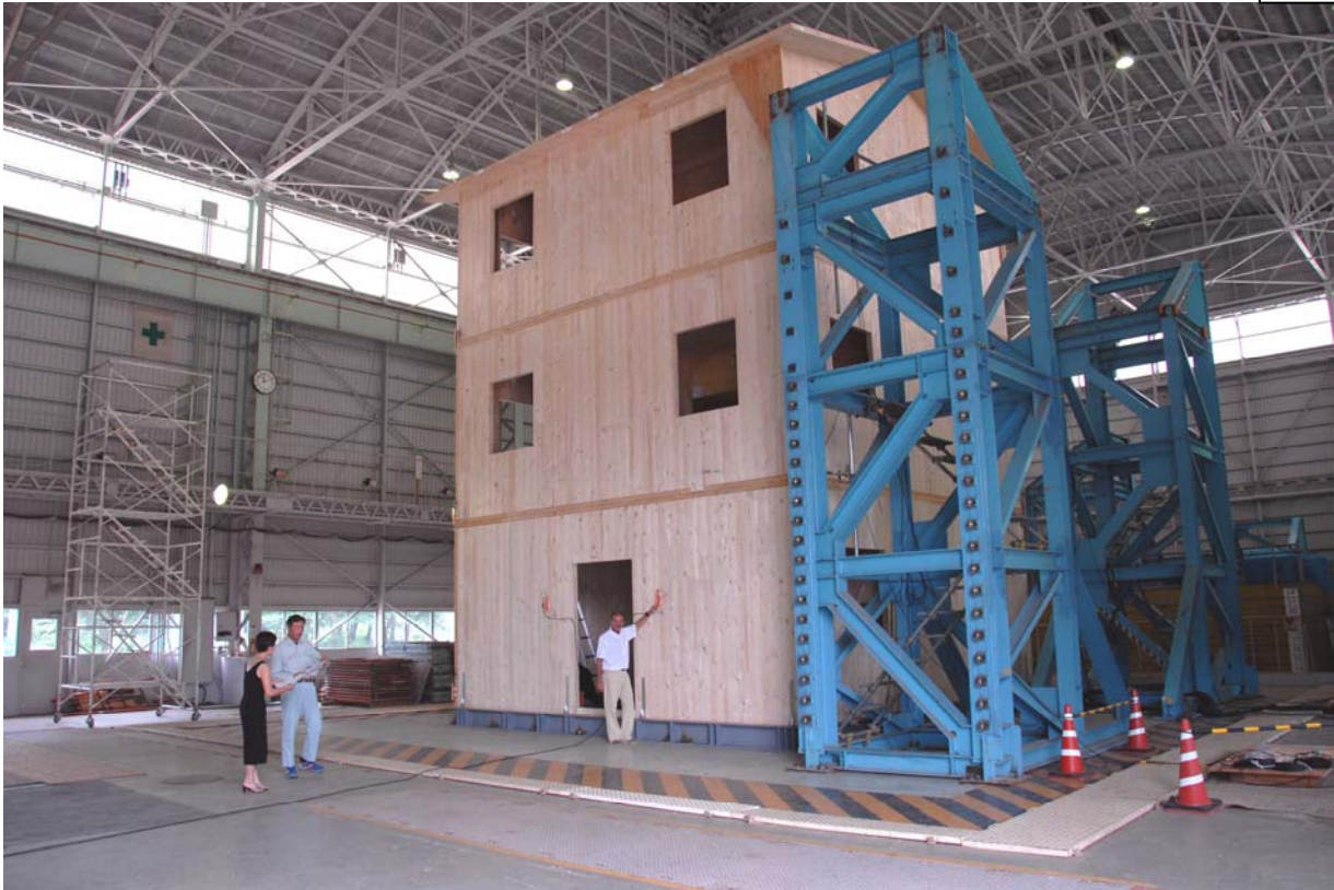
写真1：振動台に置かれた新壁式木造建物
