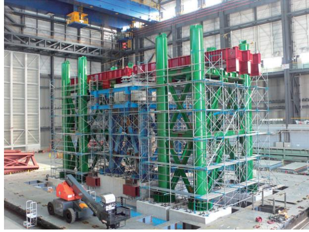
E-ディフェンス実験棟内で建設中のRC橋脚試験体及び橋梁耐震実験装置
