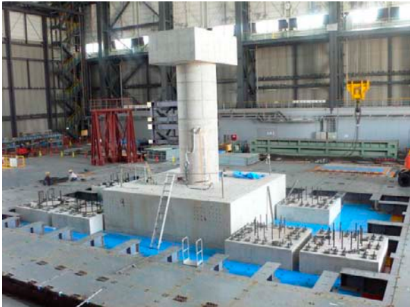
E-ディフェンス実験場内で建設中のRC橋脚試験体及び橋梁耐震実験装置
