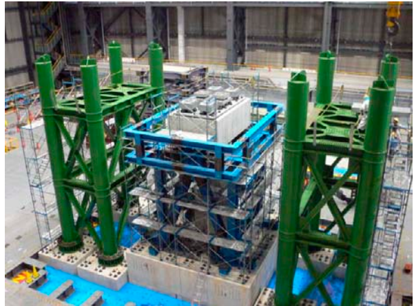
E-ディフェンス実験場内で建設中のRC橋脚試験体及び橋梁耐震実験装置
