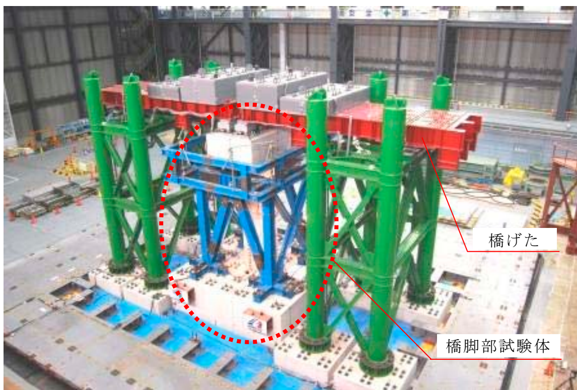
写真 1 試験体全景 橋脚部試験体(赤枠内)、橋げた(上部の赤色部分) ※赤枠内青色架台は安全装置
