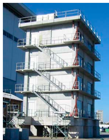
図 2 病院を模擬した試験体
