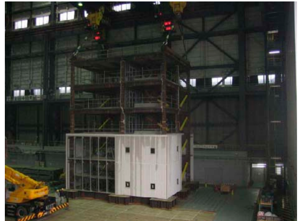
E-ディフェンス施設内で建設中の鉄骨造建物試験体
