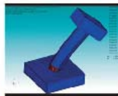
RC造橋脚実験モデル
