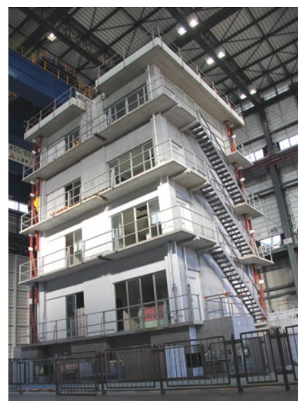
図2 病院を模擬した試験体
