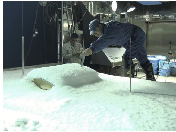
図 2-2 積雪深の測定
