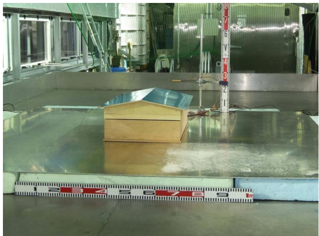
図1 使用した建物模型
