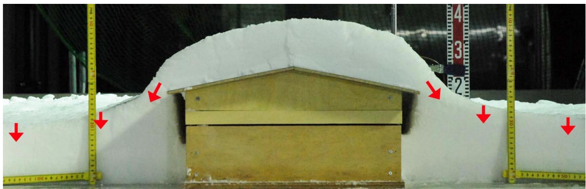
図5 屋根雪と地上雪がつながった場合の積雪表面の動き
