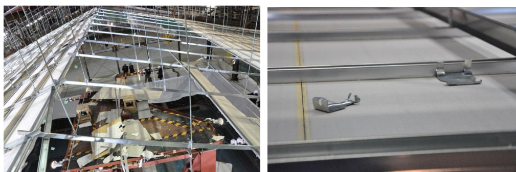
図 3 実験後の状況（左：天井裏より、右：外れた金具）
