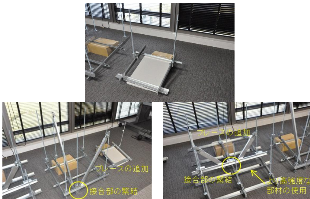
図5 天井試験体の模型（上：未対策天井、左：JIS規格材を中心とした主たる部材とした耐震天井（1.1G耐震天井）、右：JIS規格材より高強度の部材で構成した耐震天井（2.2G耐震天井））
