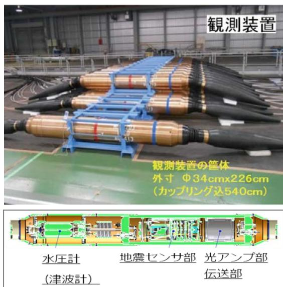
図2 観測装置の外観と内部模式図
