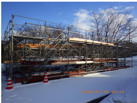
図2 試験体3,4 幅2.7m, スパン長5m, 傾斜2°, 10°
