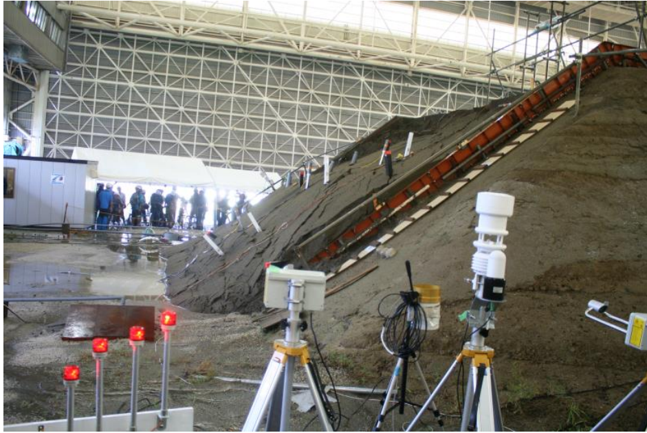
写真1：昨年度の公開斜面崩壊実験時の様子（手前：表示機器の一部、奥：崩壊時の斜面）。
