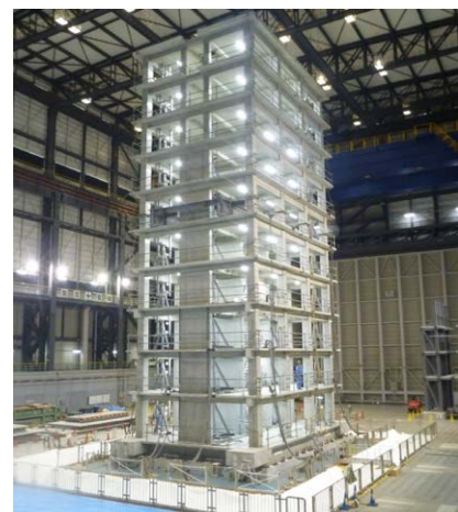
10層鉄筋コンクリート造建物の Eーディフェンス震動実験
