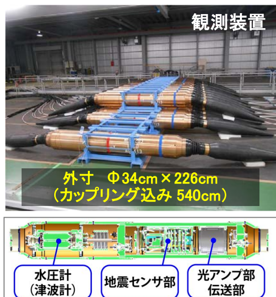
図2 観測装置の外観と内部模式図
