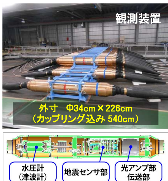
図2 観測装置の外観と内部模式図
