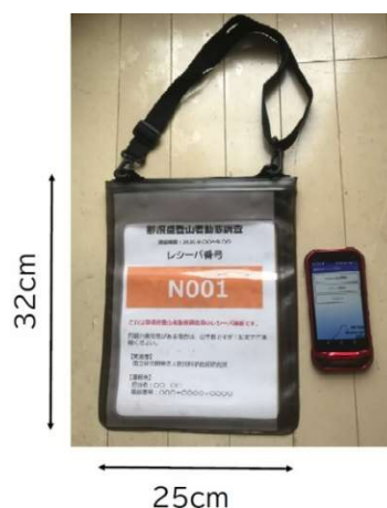
写真2. 登山道他に設置するレーザー (スマートフォン、バッテリー、ケース)
