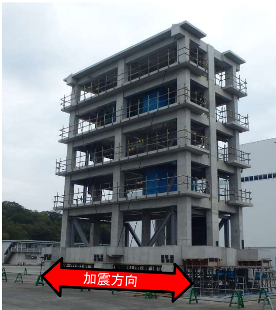
図2 試験体外観と加震方向
