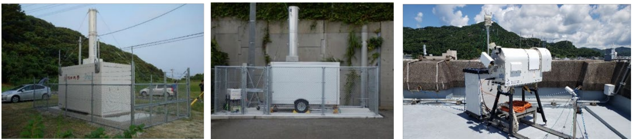
図 1 下甕島に設置した水蒸気ライダー(左)、野母崎に設置した水蒸気ライダー(中)、天草市に設置したマイクロ波放射計(右)。
