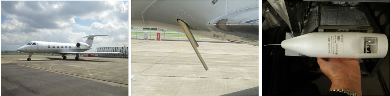
図4 飛行機観測に使用するダイヤモンドエアサービスの航空機(左)。機体からドロップゾンデを投下する装置(中)。投下するドロップゾンデ(右)。
