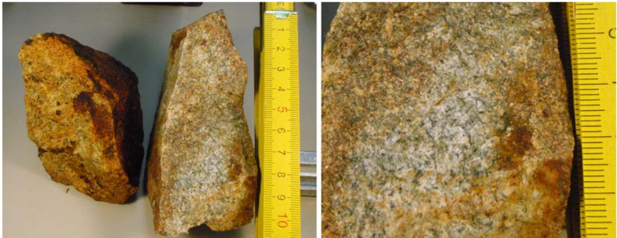
写真 1. 崩壊地 A の基盤岩石(崩壊面に露出する風化岩盤)
