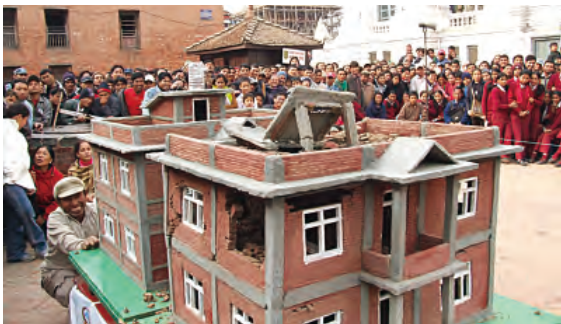
写真1 振動台実験 (手前：補強なし、奥：補強あり) (提供：NSET-Nepal)
