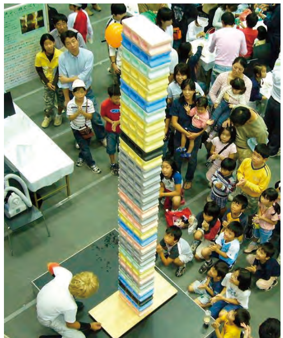
写真2 固有振動によるブロック倒し実験
