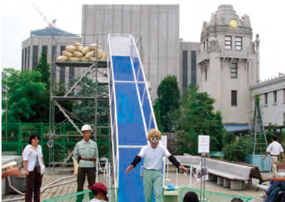
写真1 デパート屋上のピンポン球雪崩実験斜面
