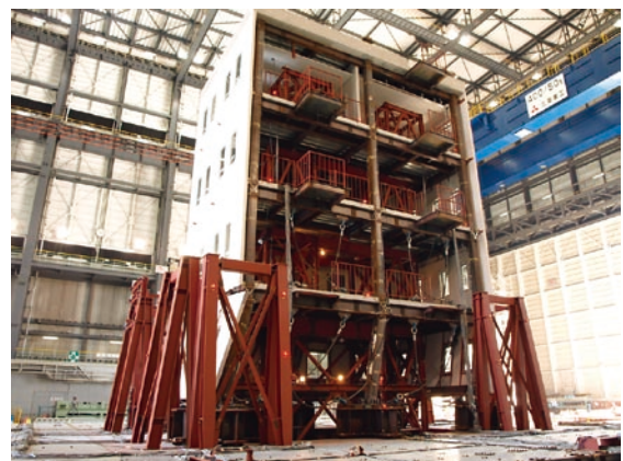
写真2 完全崩壊した4階建て鉄骨構造物
