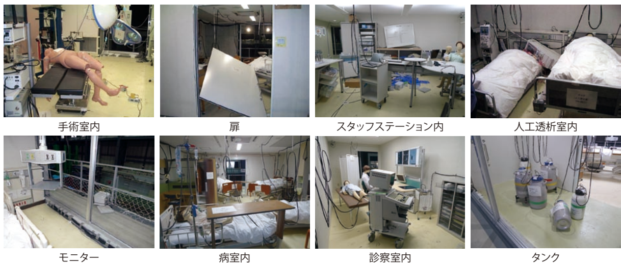
写真2 耐震構造における短周期地震波加振後の室内状況
