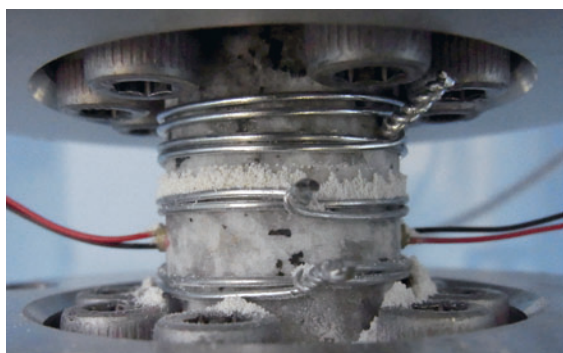
図2 岩石を用いた模擬断層面での高速すべり実験
