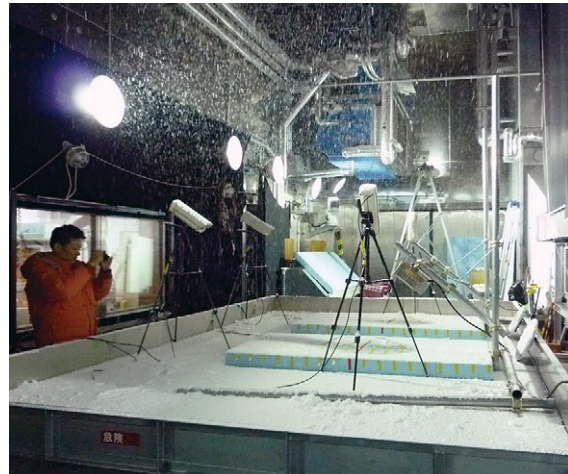
写真2 遠赤外線による融雪実験の様子
