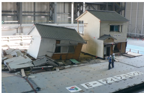
写真 耐震補強の有無による木造家屋の震動破壊実験事例
