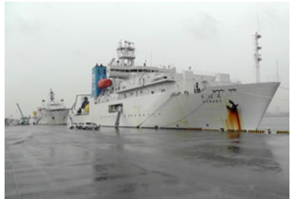
写真1 北九州市の岸壁に着岸中のNTT-WEM社敷設船「すばる」。後方は日本にあるもう1隻の敷設船KCS社の「KPL」
