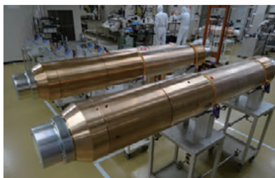
図3 地震津波計の内部の模式図と外観
