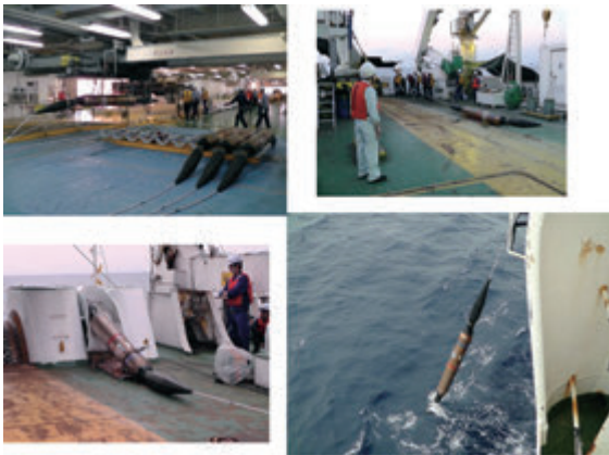
写真6 非埋設時の観測装置の投入風景。左上) ラックから船内はクレーンで移動。右上) デッキ上はソリに乗せて移動。 左下) 左舷シュータから投入開始。 右下) 海面へ着水
