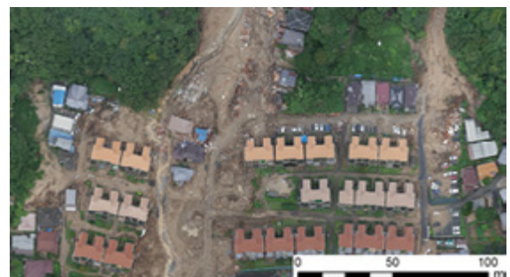
図1 八木三丁目地区（県営住宅）の写真地図 小型UAVで撮影した画像からSfM-MVS解析によりオルソモザイク画像を作成。現地対策本部には住宅地図を重ねたものを提供。（住宅地図には個人名が表示されているため、図では写真地図のみ示した。）
