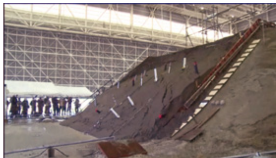
図1 崩壊後の斜面（斜面に見えるのはセンサー）
