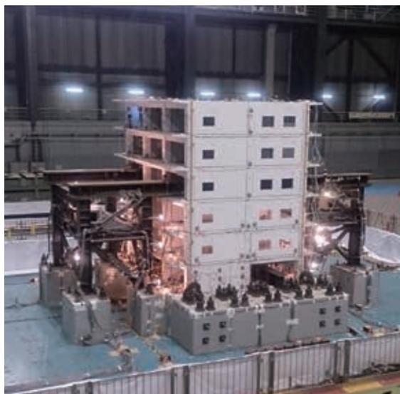
写真1 RC造6層建物の30%縮小試験体
