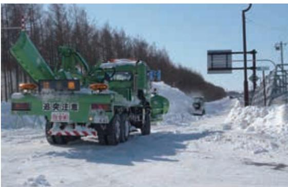
図5 吹きだまりの除雪(中標津町養老牛付近)の町道に形成された吹きだまり。2月5日撮影。
