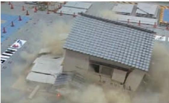
写真1 木造建物が倒壊した様子
