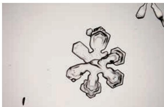
図5 月山道路の雪崩の原因となった弱層を形成する雪崩を引き起こしやすい降雪結晶
