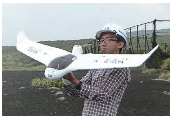
写真1 空撮用固定翼ドローン
