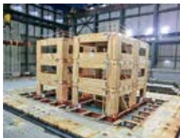
写真1 震動台搭載状況 (D棟・E棟)
