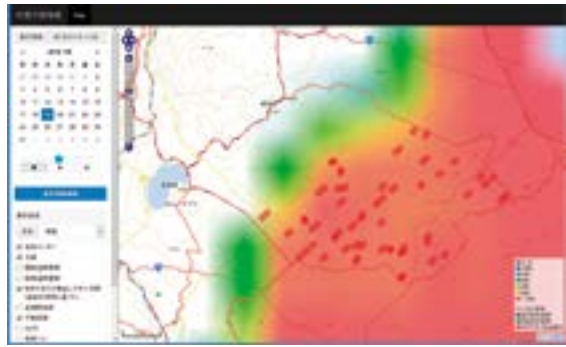
図3 吹雪リアルタイムハザードマップの視程予測画面。赤は危険なほど視程が短い状態を表す。
