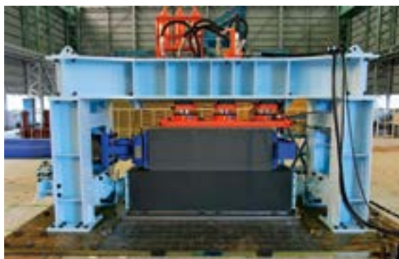
図2 大型2軸岩石摩擦試験機。大型振動台を利用し長さ2mの岩石試料を40cmずらして模擬地震を起こすことができる。
