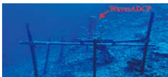
写真1 波・流れの観測装置WavesADCP設置の様子
