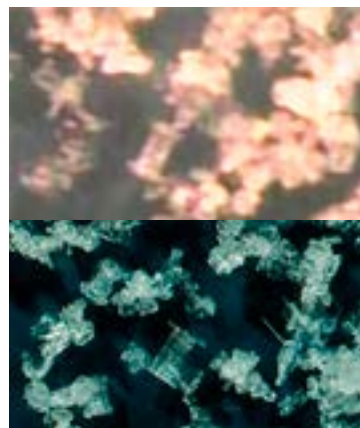
写真3 降雪粒子連続撮影装置により撮影された画像（縦横3mm×5mmで切り出し） 上：ビデオマイクロスコープ、下：一眼レフカメラ
