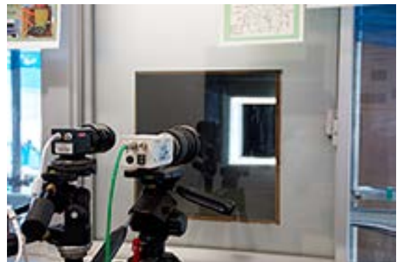
写真2 CCDカメラを用いた降雪粒子観測装置
