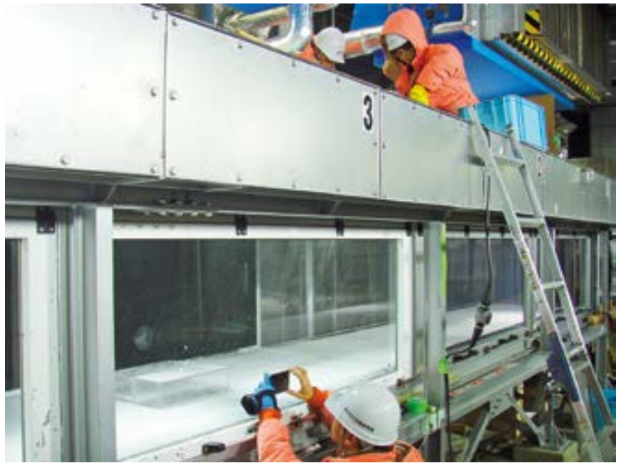
写真1 雪氷防災実験棟における風洞実験の様子（風洞内の風向は右から左）
