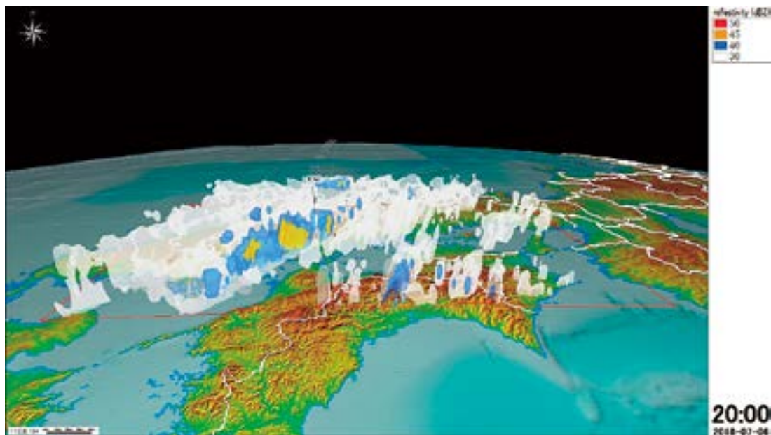
図1 気象庁Cバンドレーダーおよび国土交通省XバンドMPレーダーのデータを合成したレーダー反射因子（雨の強さ）の三次元分布。広島県南上空から見た様子。白・青・黄・赤色の等値面はそれぞれ30dBZ、40dBZ、45dBZ、50dBZのレーダー反射因子で、降雨強度3mm/時、12mm/時、24mm/時、49mm/時に対応する。図中の矢印（竿）は雲の高さを示すスケールである。地図情報は国土地理院地図（色別標高図）を利用。国土交通省XバンドMPレーダーのデータは、国家基幹技術「海洋地球観測探査システム」：データ統合・解析システム（DIAS）の枠組みの下で収集・提供されたもの。また、気象庁レーダーデータは気象業務支援センターより配信されたもの。作図は櫻井南海子主任研究員による。
