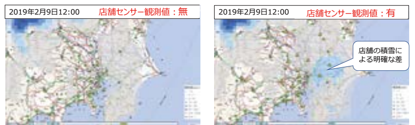
図3 2019年2月9日の積雪分布事例 (左：気象庁メソ気象モデルのみ、右：セブン・イレブンに設置したセンサーの値を追加)
