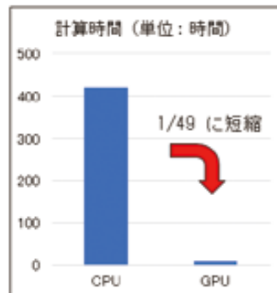
図2 1CPUと1GPUを用いた千葉県九十九里・外房地域の津波浸水計算に要する計算時間の比較
