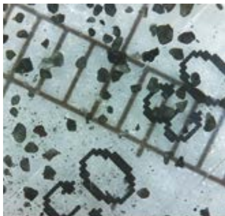
写真2：VOLCATにより霧島2018年噴火で観測された火山灰粒子画像（メモリは1mm）
