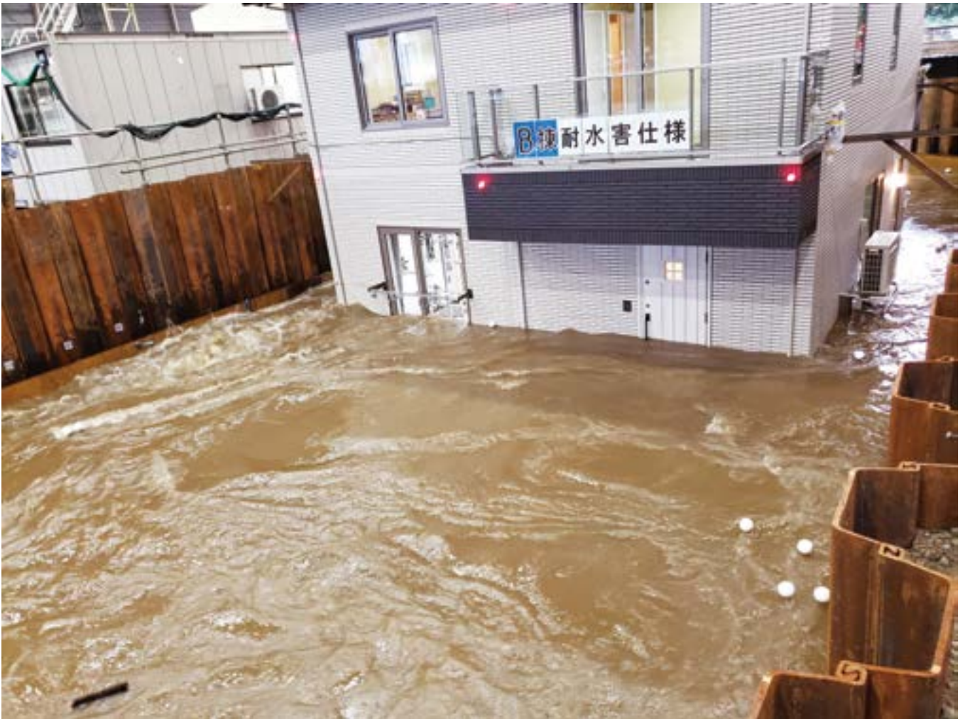
写真 実験中(水深1.4m)の耐水害住宅。中は電気がついており、室内には水は全く浸入していない。
