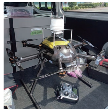
写真:地デジ水蒸気観測の検証に用いたドローン
