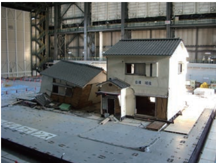
図1 木造住宅の耐震性実験
