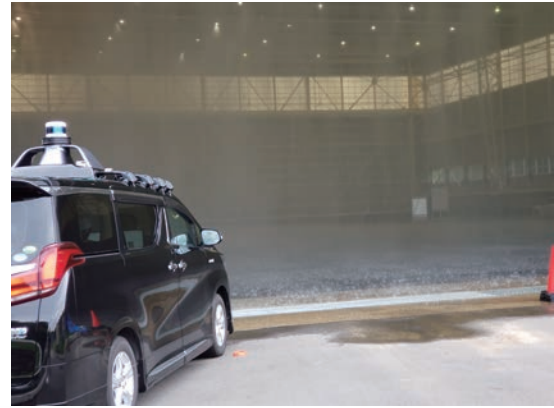
図2 降雨下の自動運転センサー検証実験
