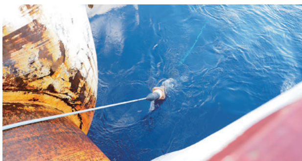
図4 船尾のケーブルシープから海底へ繰り出される観測装置の様子
